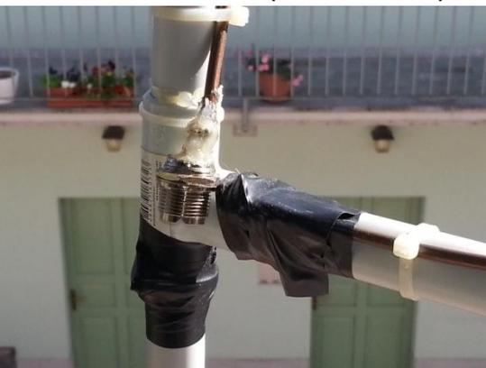
Per meglio rifinire la costruzione, si potrebbe inserire il PL in una scatoletta di plastica per proteggerlo dalle intemperie. In ogni caso conviene siliconare il PL per impedire falsi contatti dovuti a umidità o pioggia.
